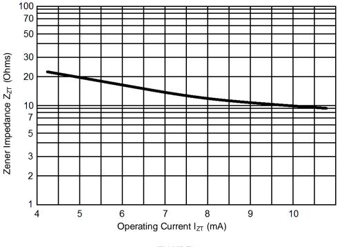
FIGURE 4 TYPICAL ZENER IMPEDANCE VS. OPERATING CURRENT
