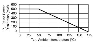
FIGURE 3 POWER DERATING CURVE
