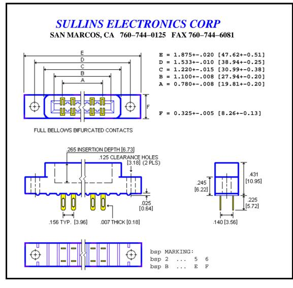
1.0 SPECIFICATIONS FOR A DUAL 6/12 POSITION EDGECARD CONNECTOR
