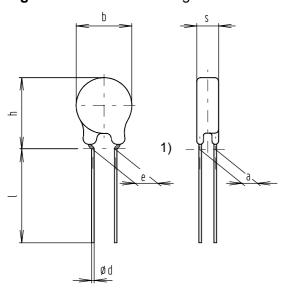
$b_{max} = 12,0$   $h_{max} = 17,5$   $s_{max} = 6,7$   $e = 7,5 \pm 0,8^{2}$   $a = 3,4 \pm 1,0$
